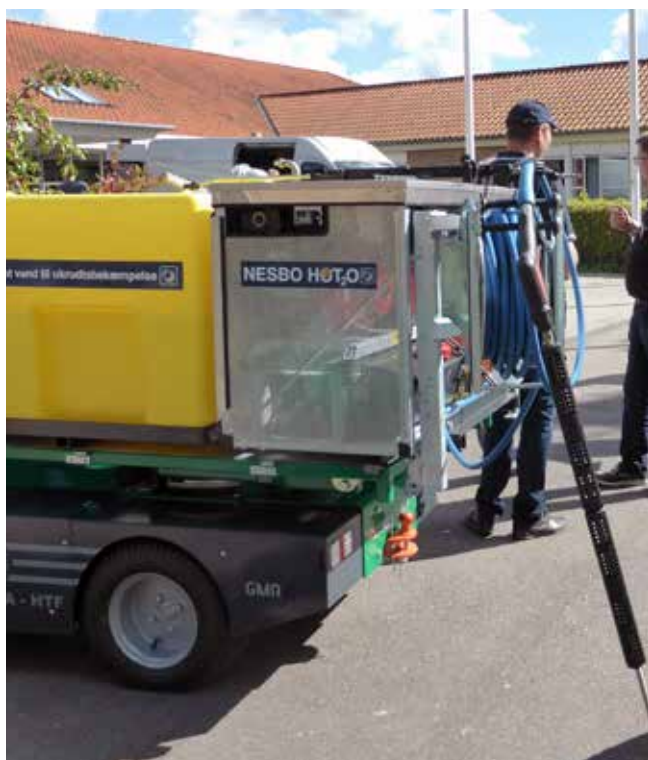
HOT 2 O er et svensk produceret anlæg til ukrudtsbekæmpelse med varmt vand. Nesbo A/S har fået agenturet i det meste af Europa og har her bygget anlægget på en el-drevet Stama/HTF Multi-truck.
