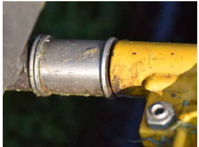
For af få den nødvendige plads til rullen, måtte bærearmerne til klipperen forlænges.
